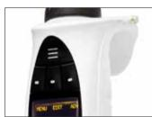
**供编程使用的按键和热键** 热键可储存多达 10 个程序
